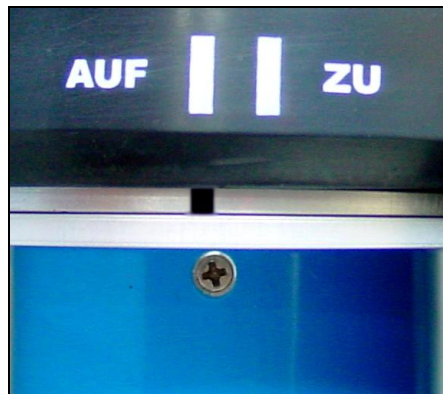
Abb. 6) Arretierung der Wandverstärkungskappe
