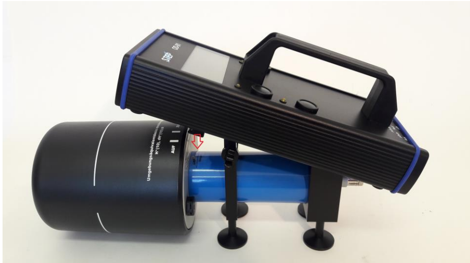
Abb. 10) Entriegelung des Anzeigeteils am Geräteträger.
