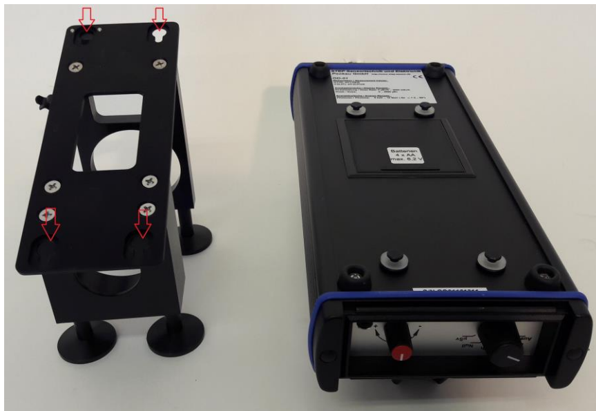
Abb. 9) Einrastprinzip Anzeigeteil / Geräteträger.
