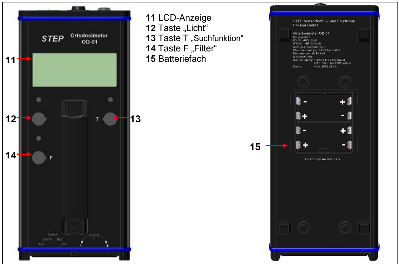
Abb. 3) Bedienelemente Front- und Rückseite
