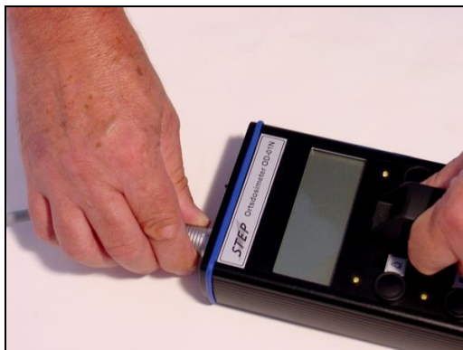
Abb. 11) Lösen der Steckverbinder Messsondenkabel.
