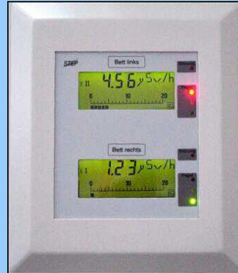
Intelligente Einzelanzeige (Typ AT1-1) bzw. Doppel-Anzeige (AT1-2) zur optischen Darstellung der Messwerte in Unterputz-Ausführung.
