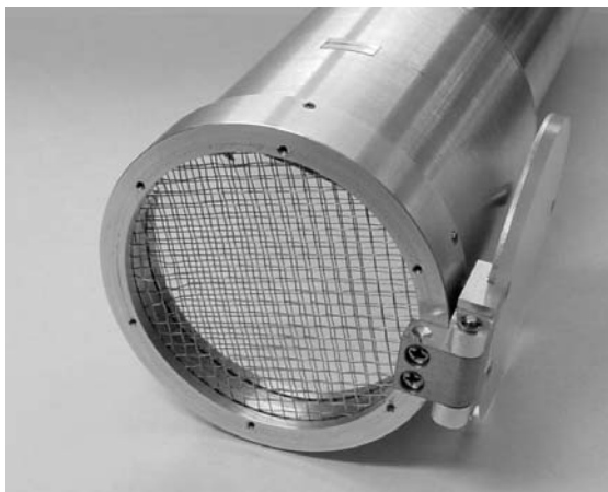
Abb. 2 Strahlungseintrittsfenster bei geöffneter Blende
